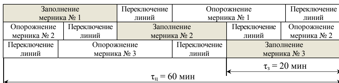
Рис. 1.2.1. Совмещенные циклограммы работы трех одинаковых мерников
