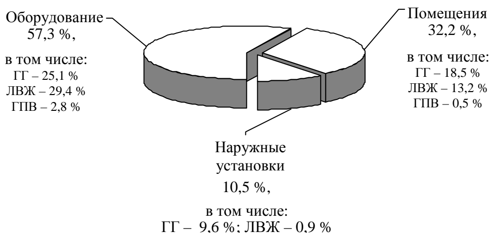
Рис. 1.4. Места образования горючих смесей:
