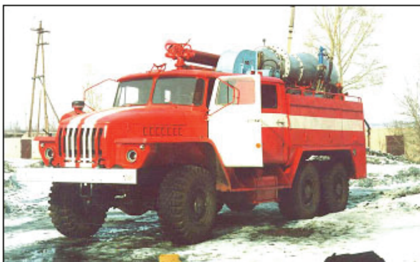
Рис. 1.2. Пожарный автомобиль с теплоэнергетической установкой на шасси Урал-375: Год разработки – 1995-й, год выпуска – 1996-й. Разработчик – Тюменская СНИЛ ВНИИПО. Заявлено: 6 л/с перегретой воды при давлении 10 атм с температурой 150–160 °С
